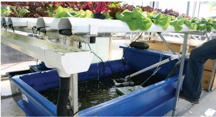
Aquaponie : ce réservoir contient des poissons-chats qui nourrissent les plantes situées au-dessus, lesquelles nourrissent les vers situés en dessous, qui nourrissent à leur tour les poissons-chats (Ryan Somma). https://commons.wikimedia.org/wiki/File:Aquaponics_with_catfish.jpg
